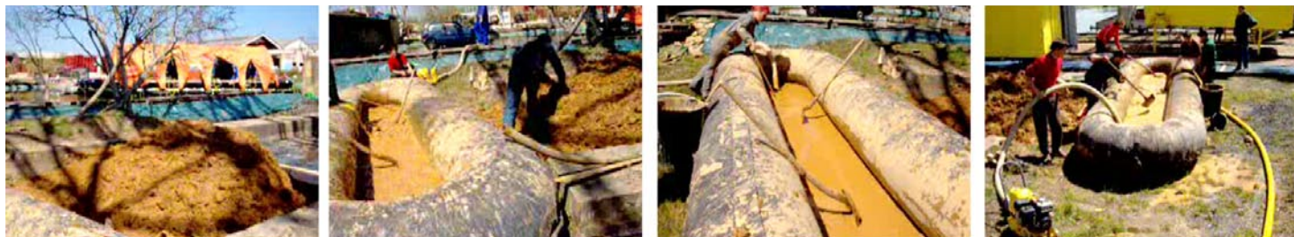
Apprêtage de la matière, dilution, brassage tenir la matière en suspension fonctionne en boucle
